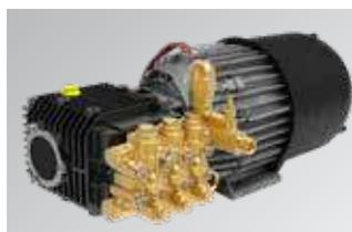
Motobomba profesional con motor de 4 polos (1400 rpm) y bomba lineal autocebante: la baja velocidad de rotación alarga significativamente la vida útil de los componentes internos de la motobomba, garantizando una mayor eficiencia y silencio
